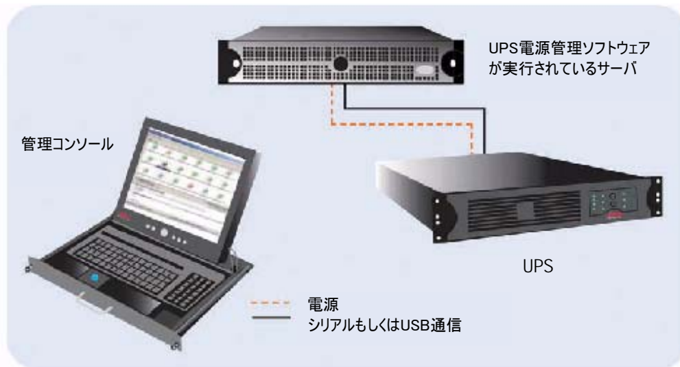
図1 - 1台のコンピュータを1台のUPSで保護する場合
