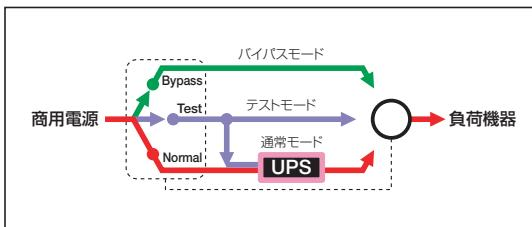
サービスバイパスパネルの系統例
