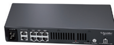
電源、制御ユニット
