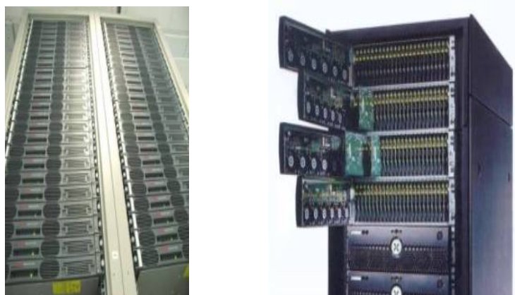
図 1 - ラックに高密度IT機器を多数搭載した例
