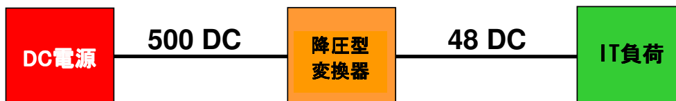
図 1e - 仮説的なハイブリッドDCシステム
