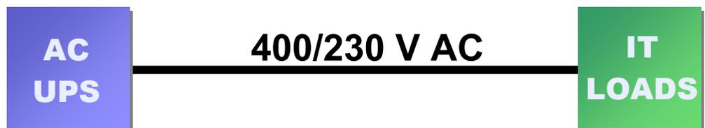
図1は、最初のシステム候補を示しています。これは北米および日本以外で一般的に使用されているAC配電システムです。北米で現在使用されている標準的な配電システムであるUPSの電圧はAC480Vで、図にはAC480VからAC208/120Vに変換するPDU変圧器を表すブロックが
