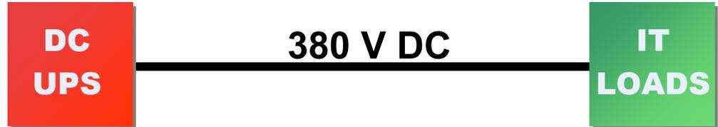
図 2 は、2 番目のシステム候補を示しています。DC380Vを配電する仮想のアプローチです。このシステムが機能するには、DC380V電源で稼動するように設計されたIT機器が存在することが必要です。このシステムは各文献で、300V、380V、400V、575VなどさまざまなDC電源電圧で提案されましたが、その中で望ましい標準は 380V程度との合意に達しているため、このホワイトペーパーの分析はDC380Vのシステムに基づいています。DC380VとDC400Vという呼び方は、基本的に同じシステムを指します。
